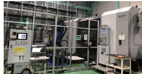
他にも切粉を圧縮する装置や、温度管理、もちろん、旋盤からの取り出しロボットやスタッカーカークレーンで棚に収容する装置まで、様々な自動化装置を組み合わせて「無人連続加工」を実現しています。
